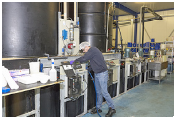
Om de productie te versnellen zijn er buffervaten met gewoon en demiwater waarmee een productieunit door zwaartekracht zeer snel gevuld is.
