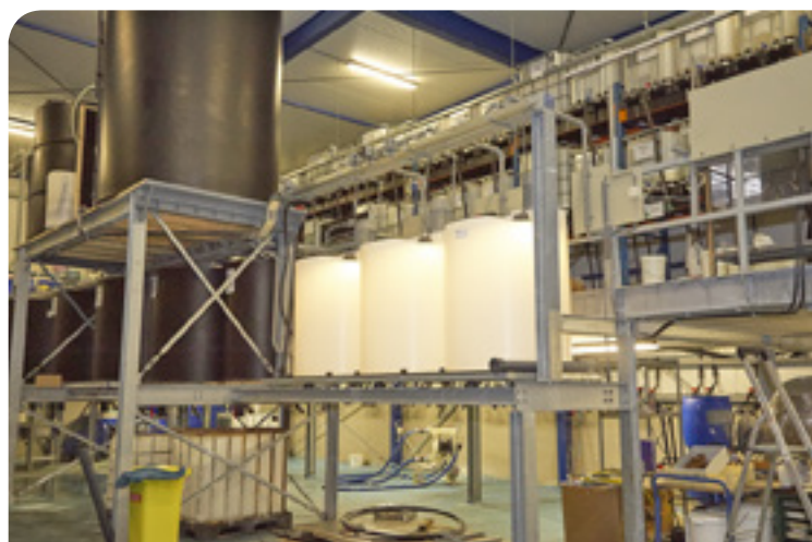
Doorzichtige verlichte productietanks maken de procesvoortgang inzichtelijk.
